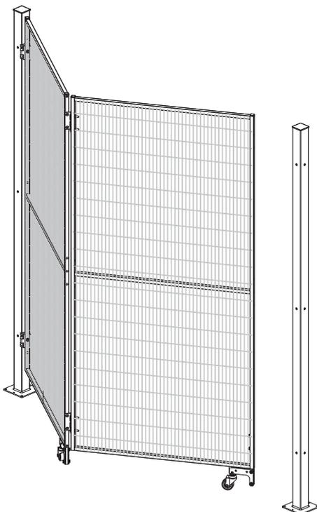
Porta articolata per contenere l'ingombro all'apertura. I due battenti si ripiegano l'uno sull'altro riducendo l'ingombro, mentre una ruota piroettante assicura la stabilità in movimento.
