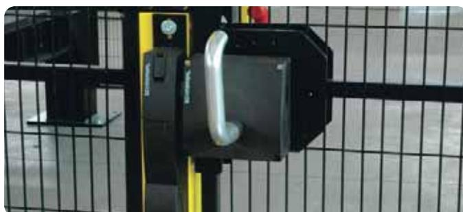
**Sistemi di chiusura adatti ad ogni Livello di Sicurezza (PLr)**
