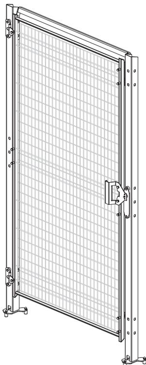
Porta per passaggio uomo con cerniere, provvista di pannello intelaiato in rete piatta saldata filo 4 e 6 mm, traversino superiore 20x30 mm e serratura a magnete.
