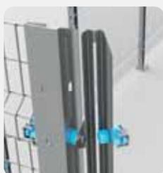
La piantana universale BlueGuard permette sia il montaggio lineare dei pannelli (180°) sia il montaggio angolare (90°). Il kit angolo variabile è un pratico accessorio che permette di unire le pannellature con un angolo compreso tra i 20° e i 70°.
