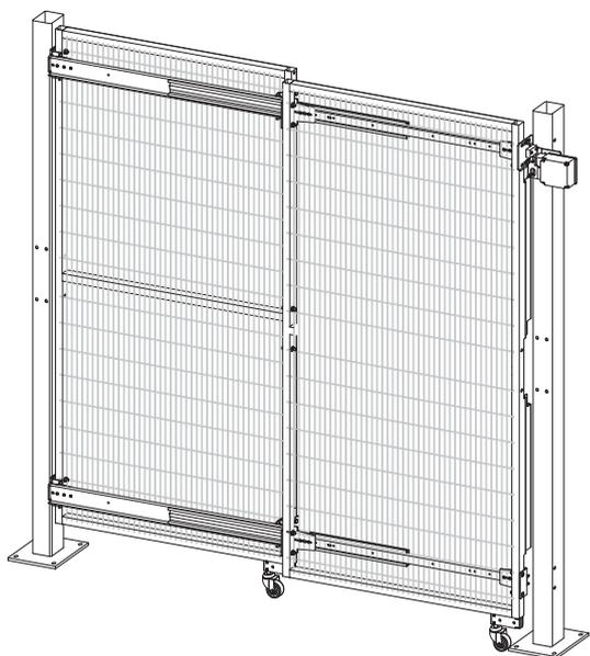
Porta che coniuga il movimento di rotazione e lo scorrimento dell'anta. Ideale nelle aree in cui gli spazi di scorrimento e rotazione del pannello porta sono limitati.
