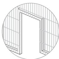
**Pannelli con dimensioni personalizzate** o con **sagomature e scantonature** per adattare la protezione a parti sporgenti del macchinario come conveyor per il carico o lo scarico, quadri di comando, linee elettriche e idrauliche.
