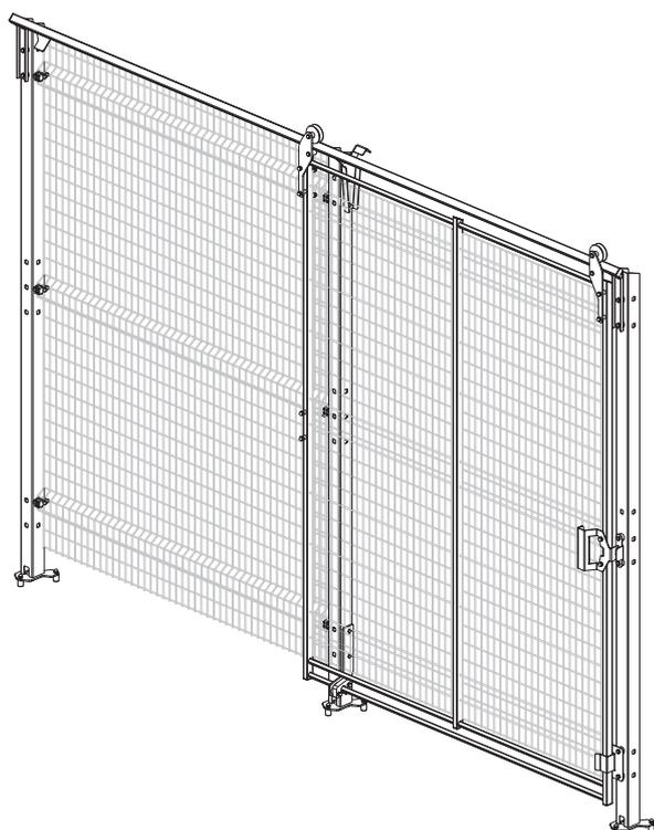
Porta scorrevole con guida superiore aperta, provvista di anta con pannello intelaiato in rete piatta saldata filo 4 e 6 mm, guida superiore 20x30 mm e serratura a magnete.
